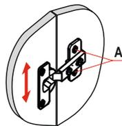
**Б) Регулирование глубины**
